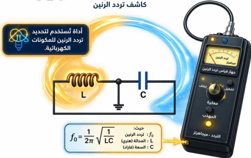
شكل (6-13): جهاز Dip Meter لقياس تردد الرنين
