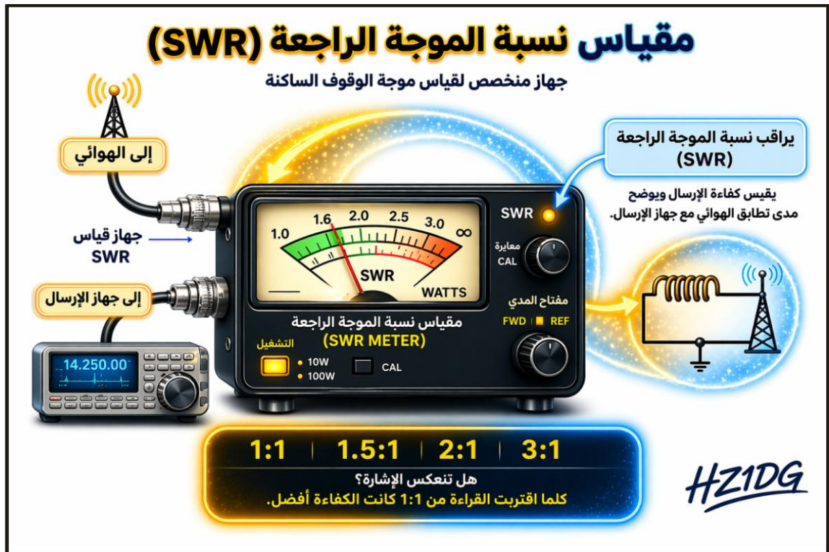
شكل (15-6): مقياس نسبة الموجة الراجعة (SWR Meter) ومراقبة كفاءة الإرسال
