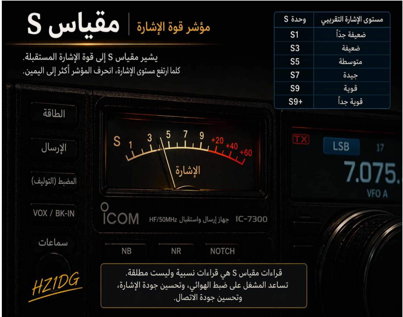
شكل (8-7): مقياس الإشارة S-Meter
