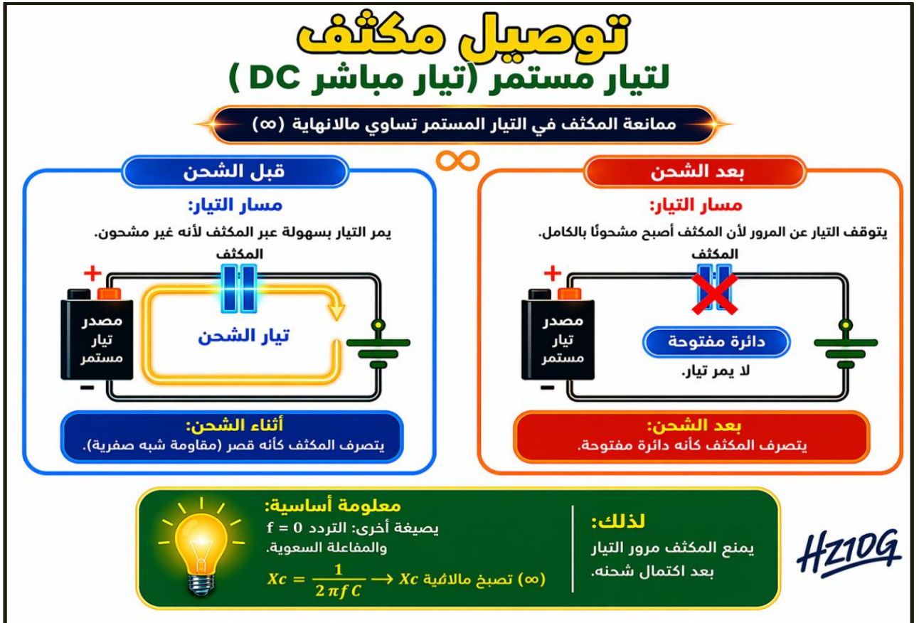
شكل (6-16): استجابة المكثف للتيار المستمر قبل وبعد الشحن
